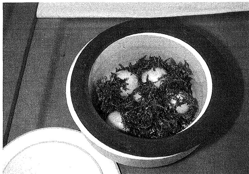
Figura 6. Contenitore in ossido di zirconio per la fase di macinatura dei muschi
