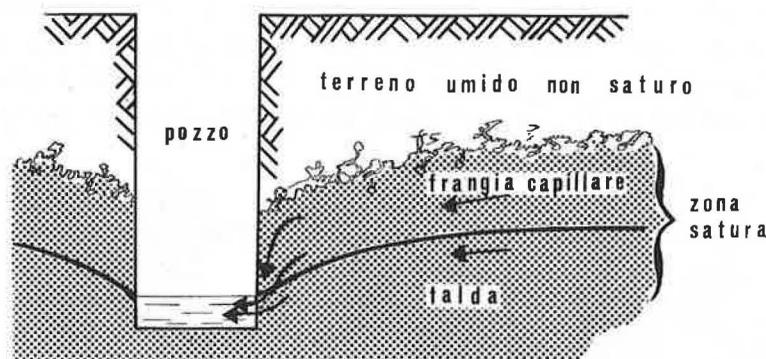
FIG. 8 — Schema di frangia capillare e sue relazioni con la falda; lungo la linea che separa la frangia capillare dalla falda, la pressione è zero.
